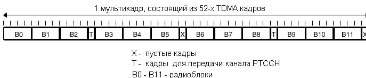
Рис.6.4. 52-кадровый мультикадр, используемый в GPRS
